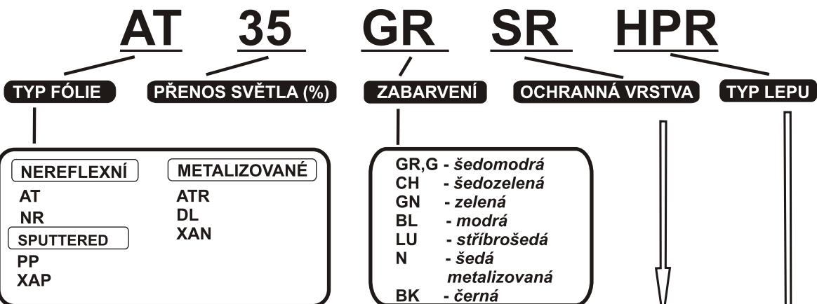
**SR - SCRATCH RESISTANT COATING** je zkratka pro vrstvu odolnou proti poškrábání. Tvrdość povrchu je zvýšená 4 až 5 krát patentem firmy CPFilms Solutia Inc.. Vrstva SR prodlužuje životnost fólie její ochranou proti abrazi při běžném užívání a čištění
